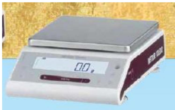
Figure 25: Balance de pesée (Portée; 820 g; précision: 0,01g)
