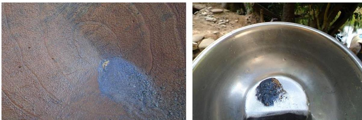
**Figure 2: Récupération de l'or par un pan en bois et un pan métallique**
