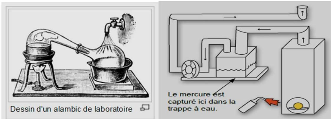
Figure 20: Equipements de récupération du mercure et contre les vapeurs mercuriques
