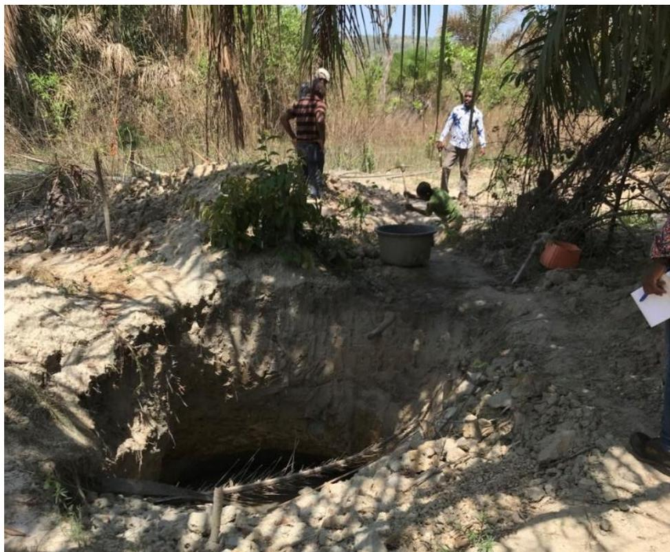
**Photo 7: Exploitation artisanale d'or à Kéméni avec un risque élevé d'effondrement des galeries**
